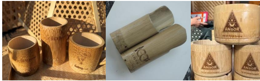
Gambar 7. Pelabelan Produk Menggunakan Laser dan Cap Bakar (Setelah Pendampingan)
