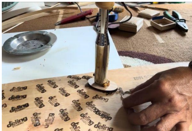
Gambar 3. Proses Label Menggunakan Alat Cap Bakar
